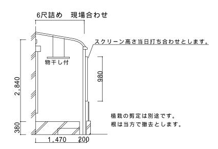
ライザーテラス R型600標準仕様 長尺柱 間口2間×出幅6尺詰め
