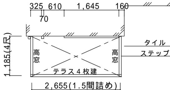
縦枠が干渉する水切り部は、切欠きさせていただきます。
