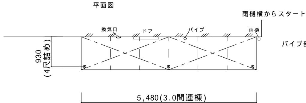
パイプ部 屋根材くり抜き有り。 雨漏れに関しては免責とさせていただきます。
